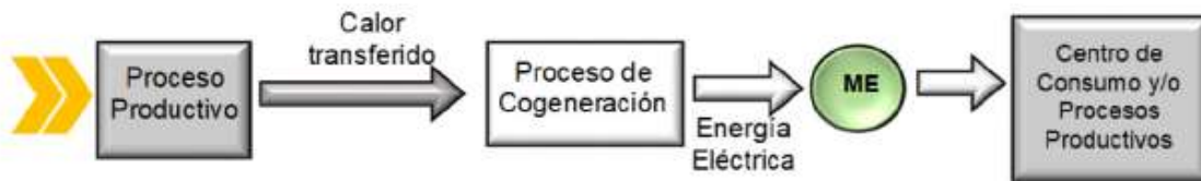
Figura 12 - Ubicación física de los sistemas de medición en procesos de Cogeneración tipo B
