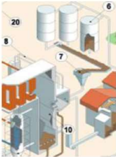
Figura B. 2 - Fragmento de un modelo de cogeneración con biomasa sólida que muestra la alimentación de la caldera (10) con una banda transportadora que cuenta al final con un dispensador (7) que controla el paso del combustible a la caldera.
