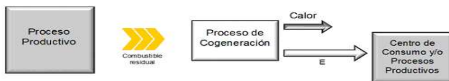
Figura 5 - Proceso de Cogeneración tipo C
