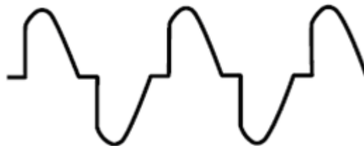
Figura 2.- Atenuador tipo corte de fase de la forma de onda de salida
