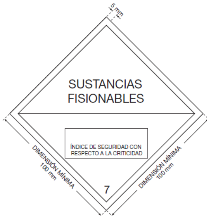
Figura A.5 Etiqueta para el ISC. El color de fondo de la etiqueta será blanco y los caracteres y líneas impresos serán negros.
