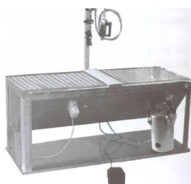
Aplicaciones spray de pegamentos a base de agua con mesa de aspiración
