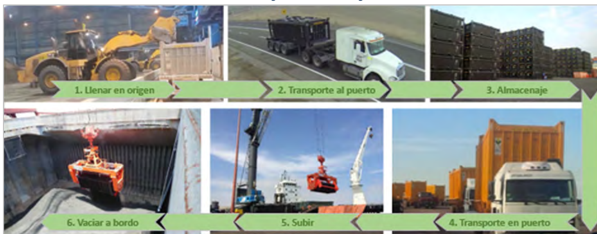
Ilustración 135 Uso de contenedores volteables desde su origen hasta su descarga en el barco
