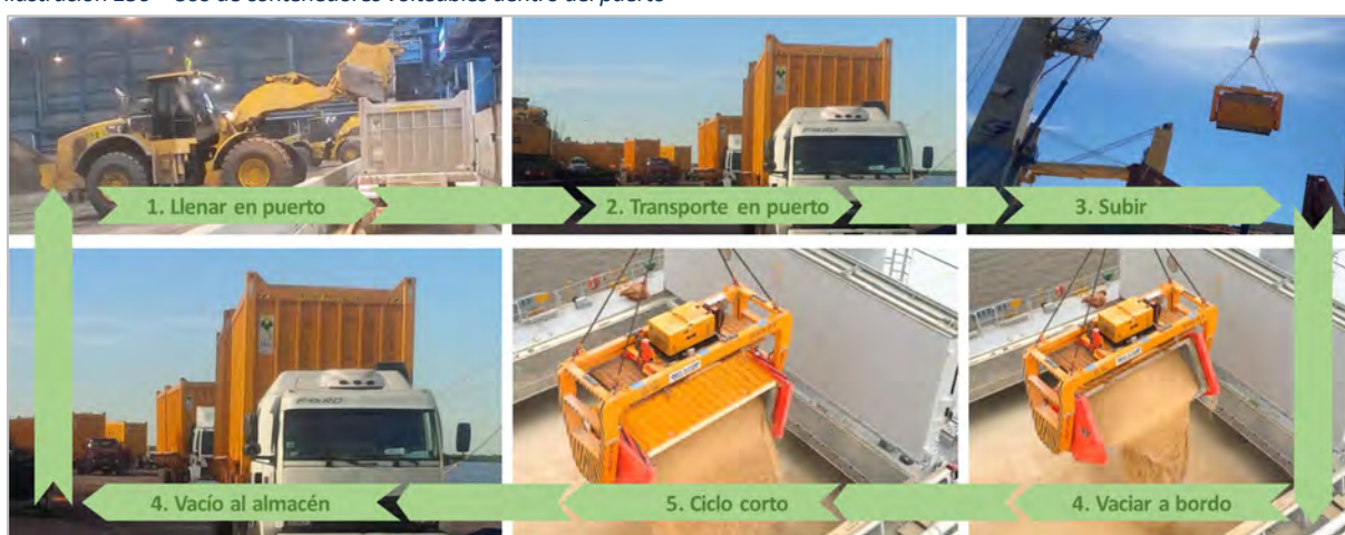
Ilustración 136 Uso de contenedores volteables dentro del puerto
