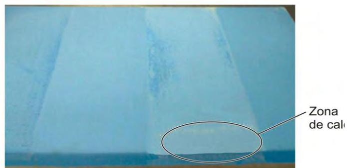
Figura C.2. Prueba finalizada con algunas zonas de entizamiento (caleo)
