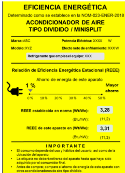
Figura A.9-Ejemplo de etiqueta para acondicionadores de aire tipo dividido, descarga libre y sin conductos de aire
