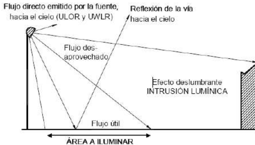
FIGURA 26. Parámetros de cálculo de la contaminación lumínica
