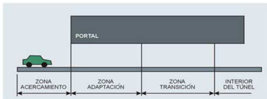
FIGURA 23. Zonas lumínicas de un túnel
