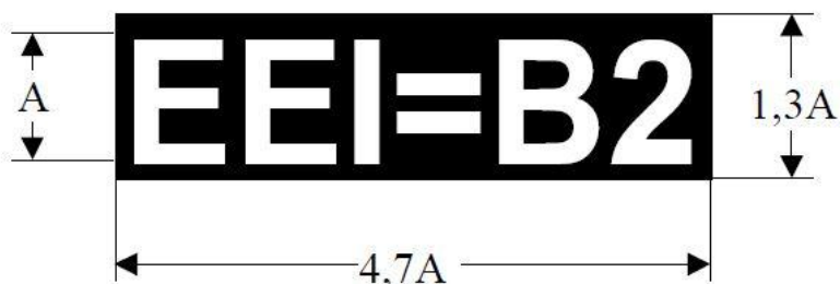
Figura 1 – Diseño de la etiqueta de eficiencia energética de balastos
