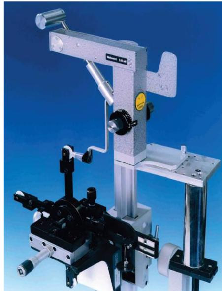
Figura 3 – Vista detallada de la instalación de prueba del tonómetro de aplanamiento (usando una balanza)
