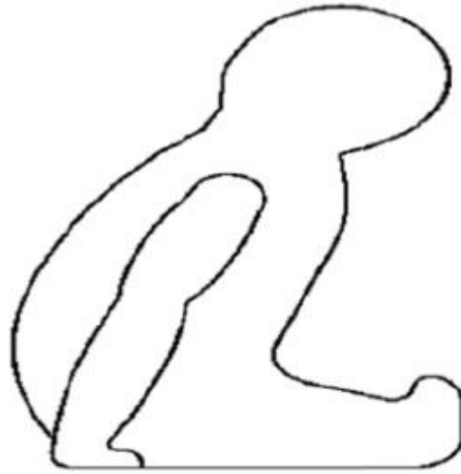
FIGURA.- 5 MANIQUÍ CONSTRUIDO DE TELA DE LONA, RELLENO DE MATERIAL, QUE TENGA UN PESO DE 12,0 kg A 15,0 kg Y UNA ALTURA DE 800 mm A 850 mm.
