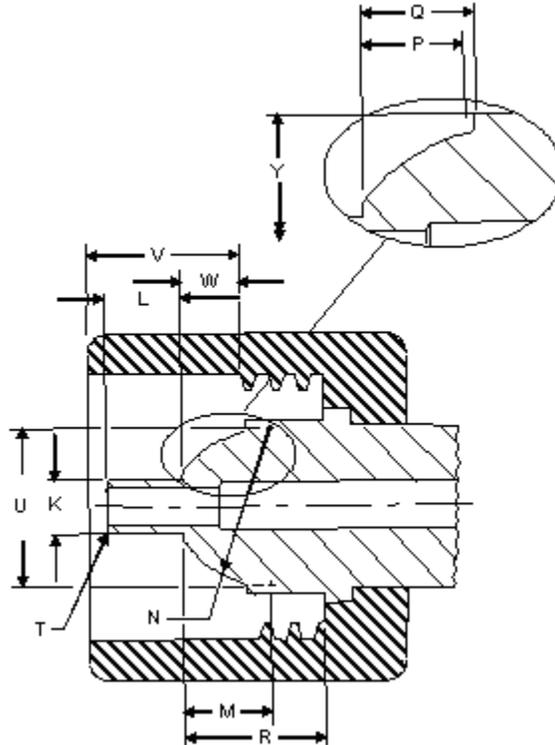
Figura 6. Conector de la rosca tipo ACME
