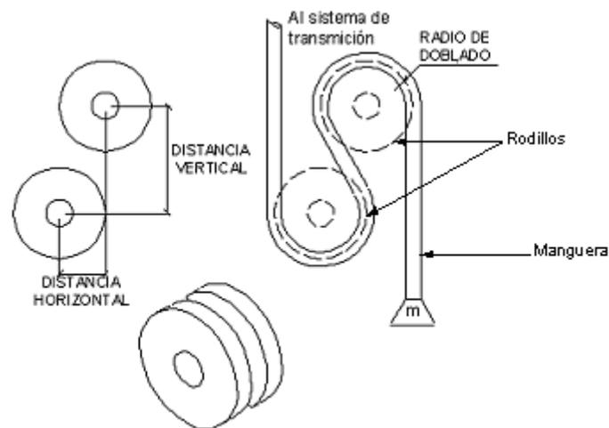
**Figura 11. Elemento de prueba de doblado y montaje del espécimen (ilustrativa, no limitativa)****7.7.5** Expresión de resultados.
