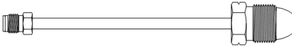
**Figura 1. Conexión integral Tipo 1 (ilustrativa, no limitativa)**
