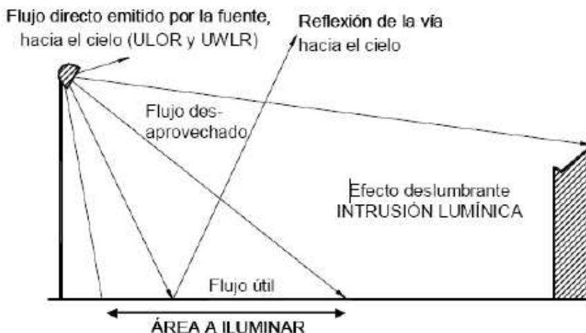
FIGURA 26. Parámetros de cálculo de la contaminación lumínica
